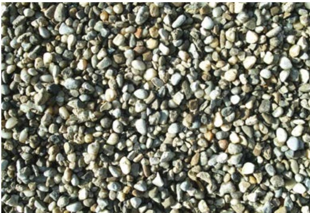
Abbildung 141: Recycling-Baustoff aus Bodenaushubmaterial
